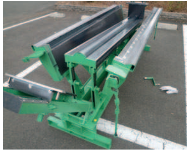
2, 3: Regulowane wymiary formy i możliwość zmiany kierunku spadku ułatwiają zmiany i pozwalają unikać błędów.
