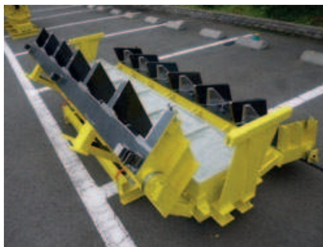
9, 10: System Furusato składa się z 6 oddzielnych bloczków połączonych ze sobą za pomocą pręta zbrojeniowego.
