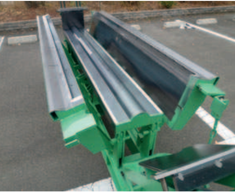
2, 3: Regulowane wymiary formy i możliwość zmiany kierunku spadku ułatwiają zmiany i pozwalają unikać błędów.
