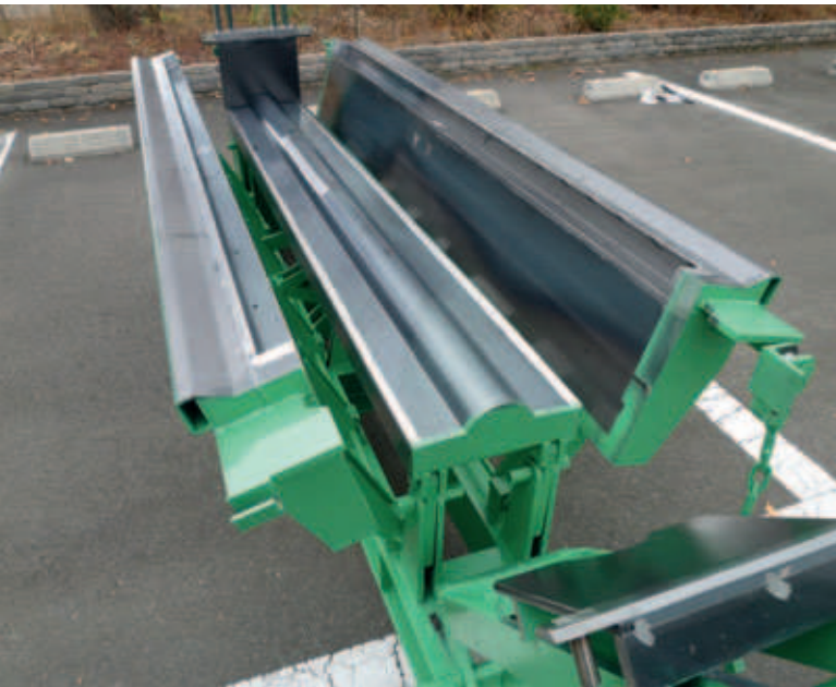
Fig. 2, 3: Cassaforma per una pendenza a regolazione variabile
