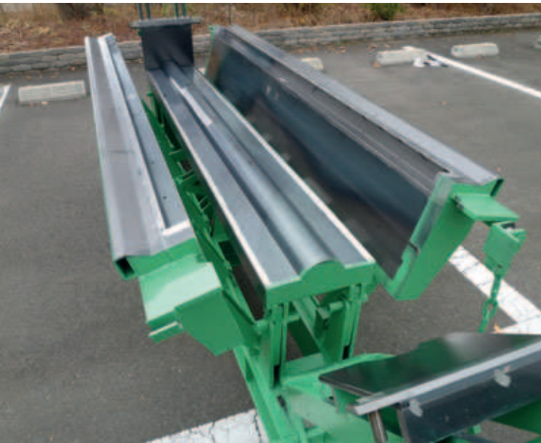
Fig. 2, 3: Moule avec changement possible du sens de la pente
