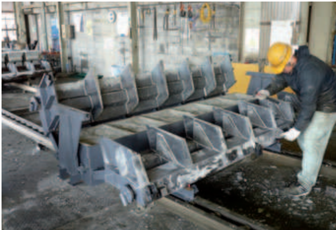
Los moldes fabricados por Toyota Forms pueden ser manipulados cómodamente por una persona.
