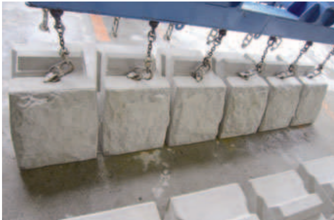
Los bloques «Furusato» pueden adaptarse a las situaciones individuales gracias a la posibilidad de libre configuración de sus radios.
