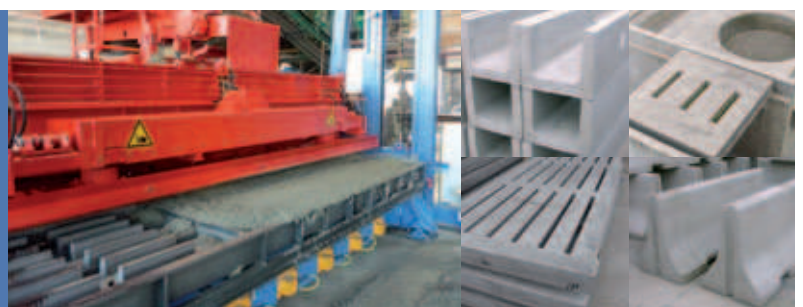
Fig. 5b : coffrage pour le bloc « Breed Rock »
