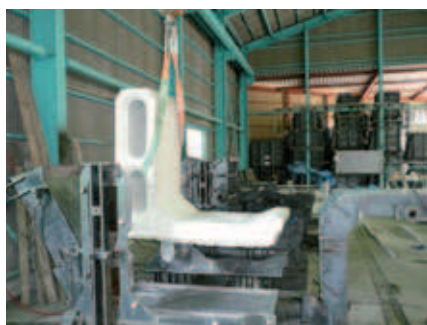
Ateliers de production avec des moules fabriqués par Toyotaforms Fig. 9: Démoulage
