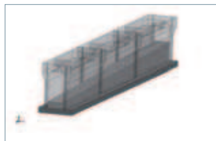
3b: Zmienne nachylenie z betonu wylewanego na placu budowy.
