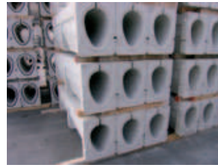
Fig. 4c: Elementi di drenaggio nel deposito
