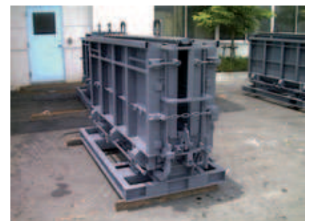
Fig. 3c: Moule de coffrage Toyota
