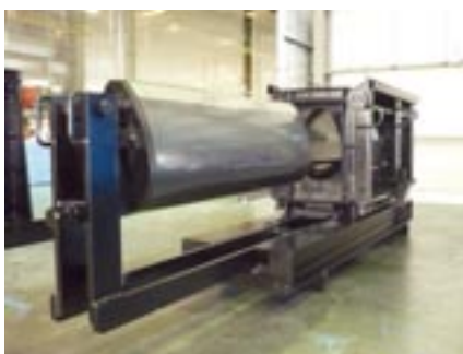
2: Forma z rdzeniem wewnętrznym typu wysuwanego.
