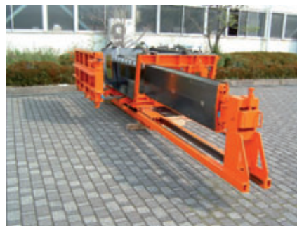
Fig. 3: Il nucleo interno viene introdotto da un lato su una slitta
