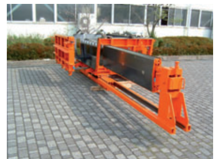
Fig. 3: Le noyau du moule est suspendu d'un côté à un rail de glissement
