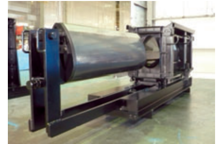
Fig. 2: Moule à noyau extractible par roulement vers l'arrière
