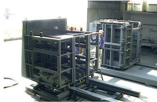
7: Regulowana forma do produkcji elementów murów oporowych typu „Road L”.
