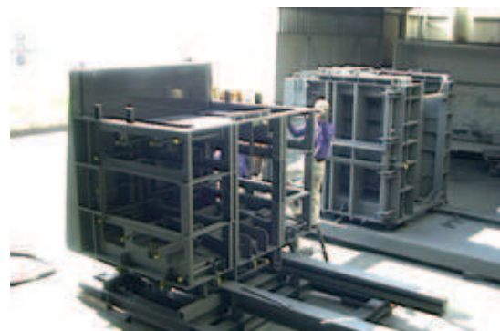
Fig. 7: Coffrage ajustable en hauteur pour mur de soutènement ,Road L'
