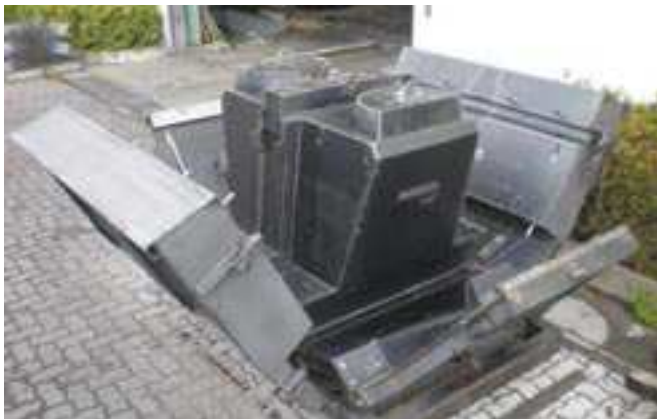
Forma do elementów ekologicznych murów oporowych.
