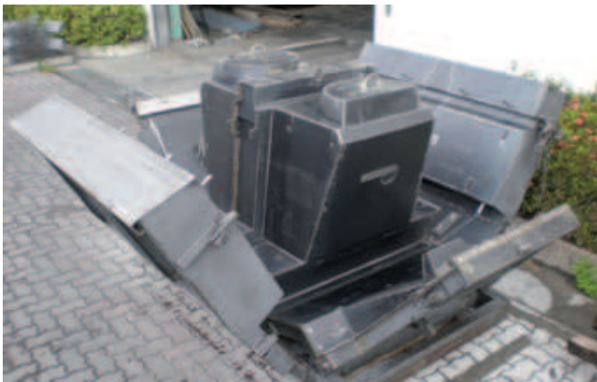
Stampo per gli elementi per i muri di contenimento
