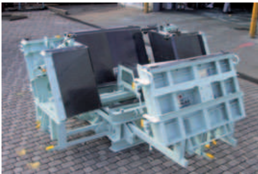
Fig. 3a, 3b: Ejemplo de los encofrados para muros de contención que se utilizan en Japón
