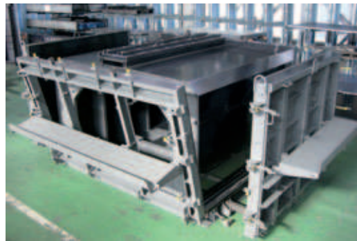
Ill. 3a, 3b: Exemple de coffrages pour murs de soutènement employés au Japon
