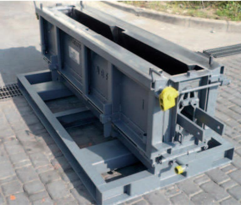
Fig. 5: Encofrado para drenajes ovoides de carreteras
