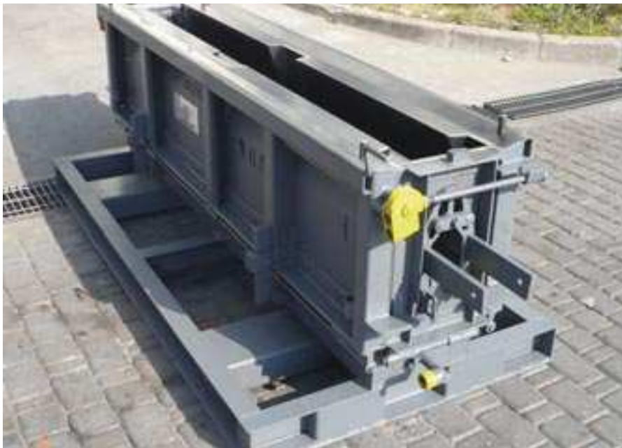
5: Forma do elementów o przekroju owalnym z jedną osią symetrii dla odwodnień drogowych.
