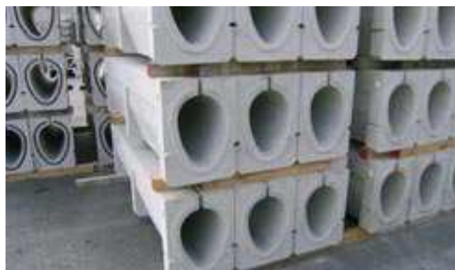
2: Elementy o przekroju owalnym z jedną osią symetrii na placu składowym.
