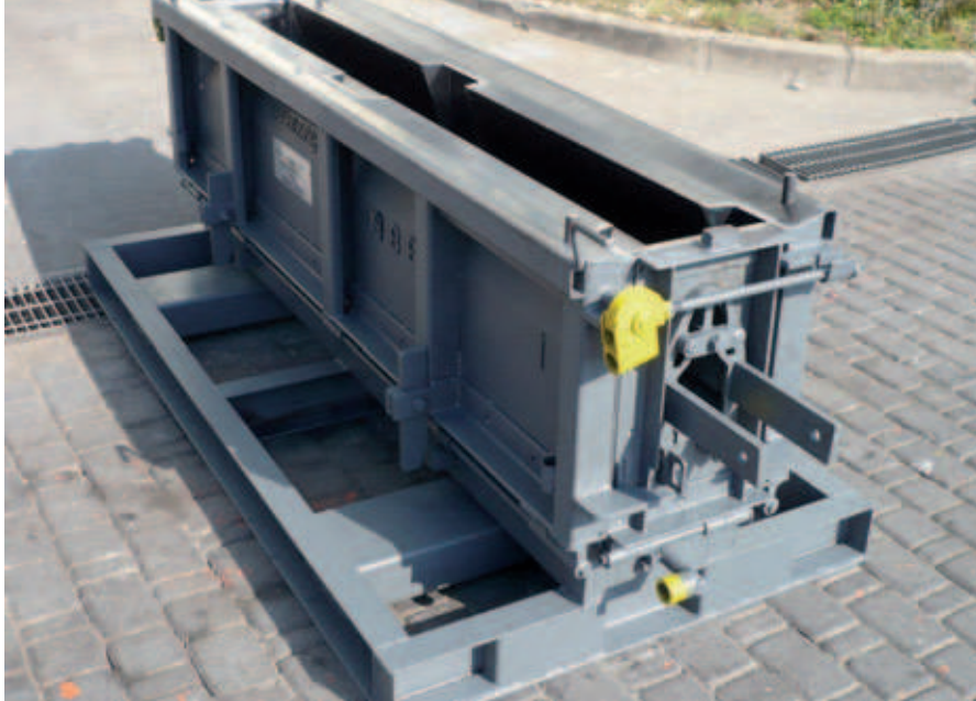
ill. 5: Coffrages pour drainages routiers de forme ovale
